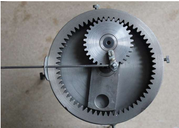
Figura 5 b e c. Realizzazione dell'exhibit del meccanismo di Tusi
